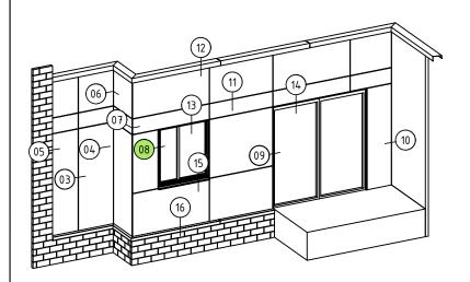
08 WINDOW JAMB DETAIL ENCLAD<sup>TM</sup> GRC PANEL
