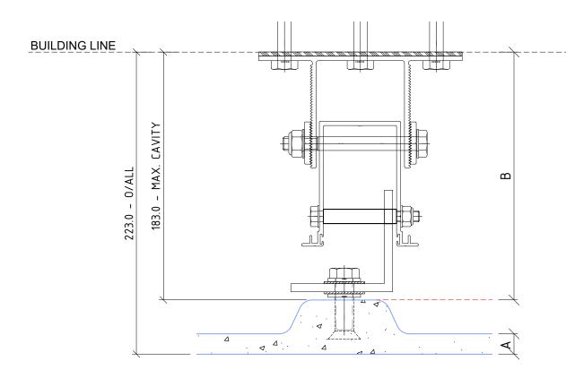
EN05-FF MINIMUM SYSTEM CAVITY 183mm
