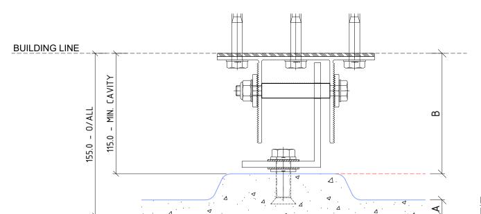
EN06 MINIMUM SYSTEM CAVITY 115mm
