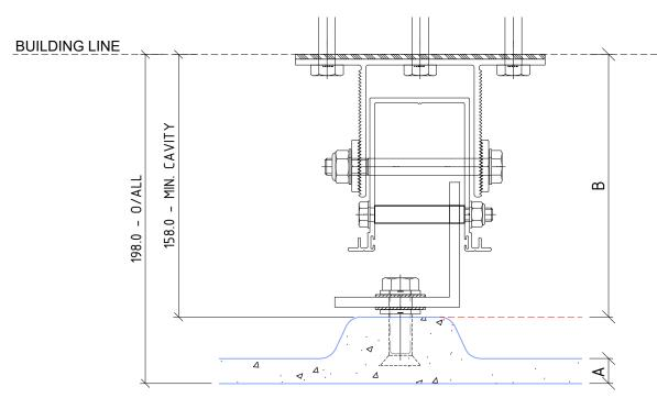
EN05-FF MINIMUM SYSTEM CAVITY 158mm
