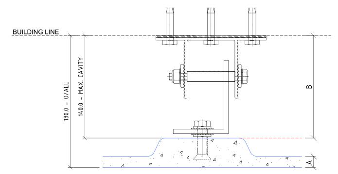
EN06 MAXIMUM SYSTEM CAVITY 140mm
